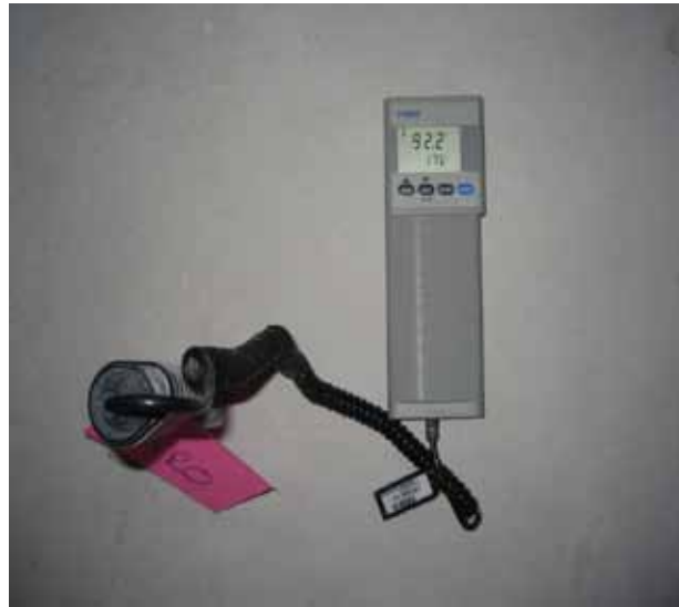
Kuva 15 Betonin suhteellisen kosteuden mittaaminen lattiaan poratusta reiästä.
