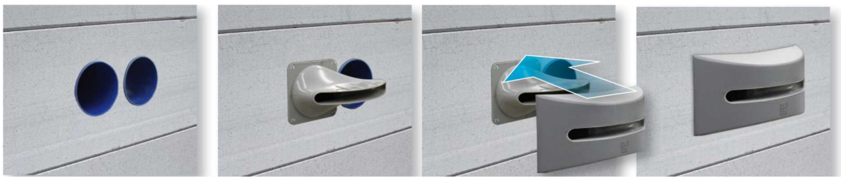
Kuva 23. Jäteilman seinäpuhallukseen tarkoitettu muovirakenteinen ulospuhalluslaite, jonka alaosassa on myös ulkoilman sisäänotto. Suurella ulospuhallusnopeudella pyritään estämään jäteilman palautuminen ulkoilman sisäänottoon (Vallox Oy).
